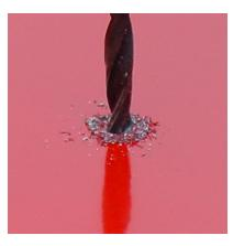
con baja rotación y limpie los orificios.
